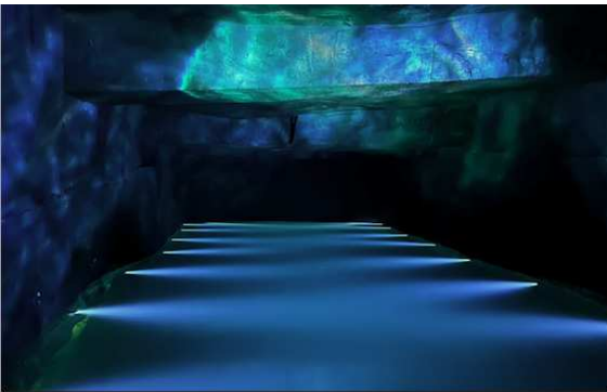
Mit Grubenwasser gefüllter Abbauraum der als Reservoir dient
