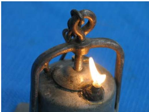
Durch Öffnen des Ventils am Wassertank kann man den Wasserfluss zum Carbid regulieren und somit durch die Gasentwicklung die Flammenhöhe einstellen. Es bildet sich Acetylen, welches durch ein Röhrchen im Wassertank zur Düse steigt. Das austretende Gas kann jetzt mit einer Feuerquelle entzündet werden.
